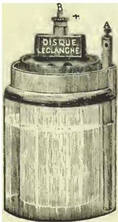
FIG. 6.-LECLANCHÉ VOLTAIC CELL.
