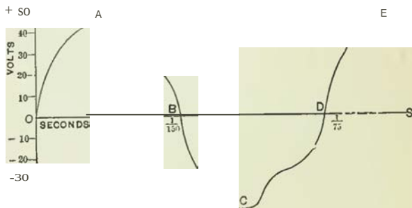
FIG. 47.-SYMMETRICAL ALTERNATING E. I. F.
