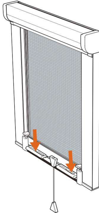
2 - Pour l'ouverture, aidez-vous des poignées. Il vous suffit de pousser les poignées pour déclencher le mécanisme d'ouverture.
