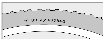
Exemple d'une indication de pression
