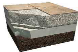
NEU WUSA-SYSTEM Kleben auf Splitt + sickertfähig Verfugen möglich
