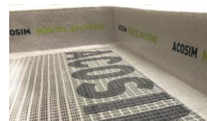
RANDDÄMMSTREIFEN Art. Nr. RDS 15 Farbe: grau Höhe: 15 cm Stärke: 10 mm (Norm) Länge: 50 ml (Rolle) Randdämmstreifen mit Selbstklebefuss
