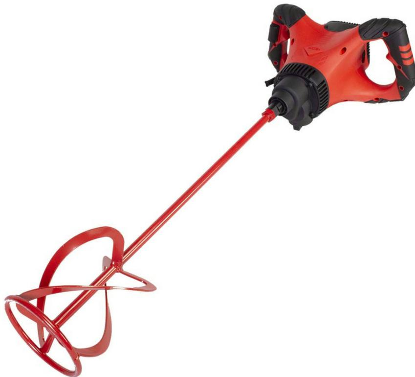
Es un mezclador eléctrico apto para un amplio abanico de materiales; adhesivos cementosos, resinas, pinturas, etc. su gran fuerza (torque de 40,2 Nm). Este par de giro o torque es necesario para poder realizar mezclas en materiales de elevada viscosidad sin que el equipo se sobreesfuerce innecesariamente. Su caja reductora de dos velocidades mecánicas permiten escoger entre dos rangos de RPM; de 0 a 4560 y de 0 a 780.
