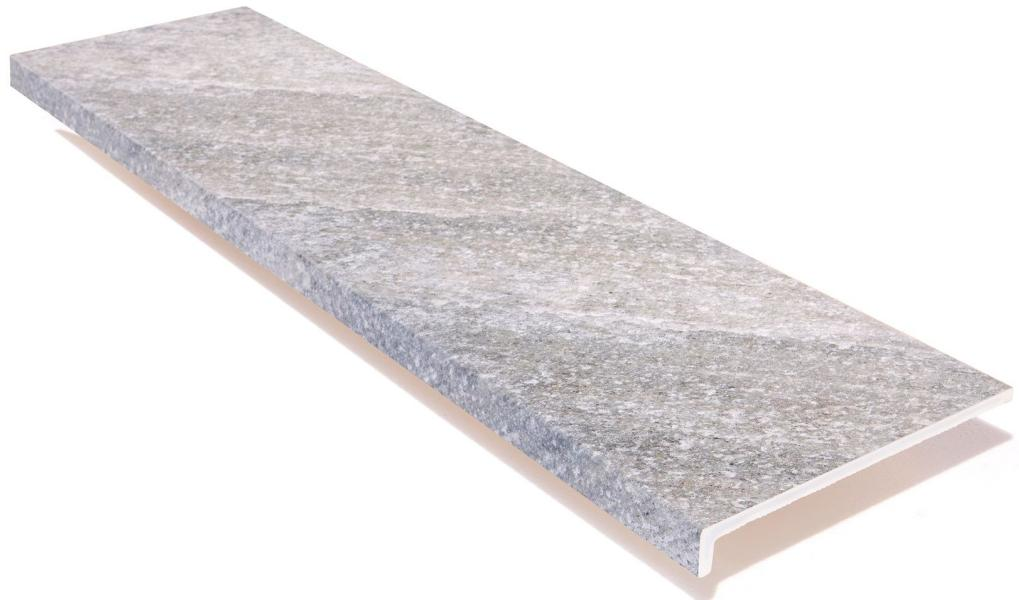
**DATOS TÉCNICOS****NOMBRE:** Peldaño Oberon Stone**CÓDIGO:** PM01499**SERIE:** Oberon**FORMATO:** 31.7x120 Peldaño Recto**TIPO DE PIEZA:** Pieza Especial**TIPO DE PASTA:** Porcelánico**ASPECTO:** Piedras**ACABADO:** Mate**USO:** Pavimento**DESTONIFICACIÓN:** V4 Considerable**DESLIZAMIENTO NORMA UNE:** Clase 3**% ABSORCIÓN:** E < 0.5%**RESISTENTE A HELADA:** Sí**MOHS:** 5**NOTAS:** Formato no representa la realidad del producto**PEI:** 4
