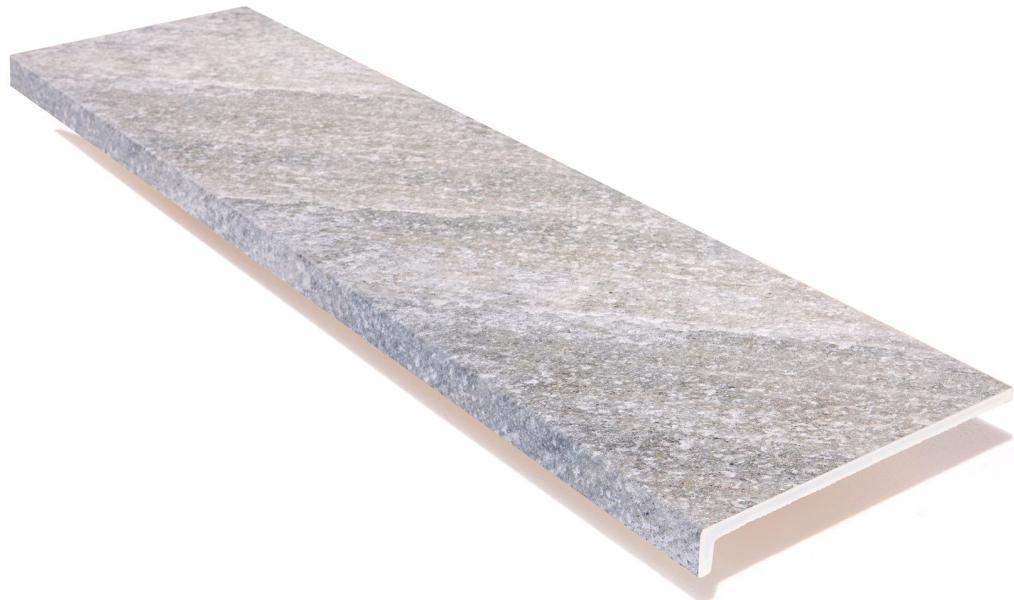
**DONNÉES TECHNIQUES****NOM:** Peldaño Oberon Stone**CODE:** PM01499**SÉRIE:** Oberon**FORMAT:** 31.7x120 Peldaño Recto**TYPE DE PIÈCES:** Pièce Spéciale**TYPE DE SUPPORT:** Grès Cérame**ASPECT:** Stone**FINITION:** Mate**USAGE:** Sol**DESTONATION:** V4 Considérable**GLISSEMENT - NORME UNE:** Clase 3**% ABSORPTION:** E < 0.5%**RÉSISTANT AU GEL:** OUI**MOHS:** 5**NOTES:** Formato no representa la realidad del producto**PEI:** 4
