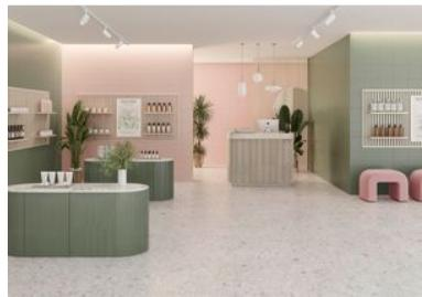
**DONNÉES TECHNIQUES****NOM:** Iseo Light**CODE:** PT06627**SÉRIE:** Iseo**FORMAT:** 66x66**TYPE DE PIÈCES:** BASE**TYPE DE SUPPORT:** Grès Cérame**ASPECT:** Stone**FINITION:** Mate**USAGE:** Sol et Mur**DESTONATION:** V3 Modéré**GLISSEMENT - NORME UNE:** Clase 1**% ABSORPTION:** E < 0.5%**RÉSISTANT AU GEL:** OUI**NOMBRE DE VISAGES:** 9
