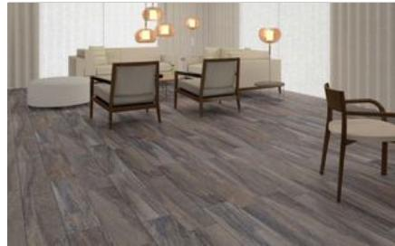
**DATOS TÉCNICOS****NOMBRE:** Canaima Taupe**CÓDIGO:** PT03812**SERIE:** Canaima**FORMATO:** 22x90**TIPO DE PIEZA:** Base**TIPO DE PASTA:** Porcelánico**ASPECTO:** Madera**ACABADO:** Satinado**USO:** Pavimento/Revestimiento**DESTONIFICACIÓN:** V4 Considerable**DESLIZAMIENTO NORMA UNE:** Clase 1**% ABSORCIÓN:** E < 0.5%**RESISTENTE A HELADA:** Sí**MOHS:** -**Nº DE CARAS:** 10**PEI:** -
