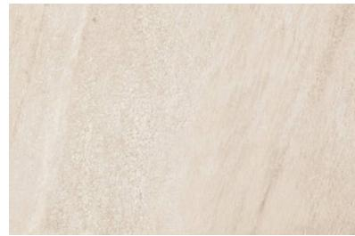
**DATOS TÉCNICOS****NOMBRE:** Tracia Sand**CÓDIGO:** PT05833**SERIE:** Tracia**FORMATO:** 44x66**TIPO DE PIEZA:** Base**TIPO DE PASTA:** Porcelánico**ASPECTO:** Piedras**ACABADO:** Mate**USO:** Pavimento/Revestimiento**DESTONIFICACIÓN:** V3 Moderada**DESLIZAMIENTO NORMA UNE:** Clase 3**% ABSORCIÓN:** E < 0.5%**RESISTENTE A HELADA:** Sí
