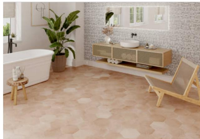
**DATOS TÉCNICOS****NOMBRE:** Aspdin Cotto Hex25**CÓDIGO:** PT06722**SERIE:** Aspdin**FORMATO:** 22x25 Hexagonal**TIPO DE PIEZA:** Base**TIPO DE PASTA:** Porcelánico**ASPECTO:** Barro**ACABADO:** Mate**USO:** Pavimento/Revestimiento**DESTONIFICACIÓN:** V4 Considerable**DESLIZAMIENTO NORMA UNE:** Clase 3**% ABSORCIÓN:** E < 0.5%**RESISTENTE A HELADA:** Sí**MOHS:** -**Nº DE CARAS:** 52**PEI:** -
