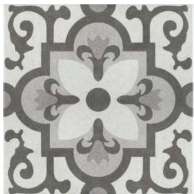
**DATOS TÉCNICOS****NOMBRE:** Vintage Mix**CÓDIGO:** PT03050**SERIE:** Vintage**FORMATO:** 25x25**TIPO DE PIEZA:** Base Decorada**TIPO DE PASTA:** Porcelánico**ASPECTO:** Hidráulico**ACABADO:** Satinado**USO:** Pavimento/Revestimiento**DESTONIFICACIÓN:** V3 Moderada**DESLIZAMIENTO NORMA UNE:** Clase 1**% ABSORCIÓN:** E < 0.5%**RESISTENTE A HELADA:** Sí**Nº DE CARAS:** 22
