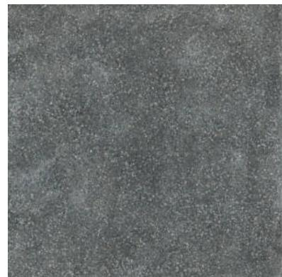
**DATOS TÉCNICOS****NOMBRE:** CALGARY BLACK**CÓDIGO:** PT06303**SERIE:** Calgary**FORMATO:** 66x66**TIPO DE PIEZA:** Base**TIPO DE PASTA:** Porcelánico**ASPECTO:** Piedras**ACABADO:** Mate**USO:** Pavimento/Revestimiento**DESTONIFICACIÓN:** V2 Ligera**DESLIZAMIENTO NORMA UNE:** Clase 3**% ABSORCIÓN:** E < 0.5%**RESISTENTE A HELADA:** Sí**MOHS:** -**Nº DE CARAS:** 16**PEI:** -
