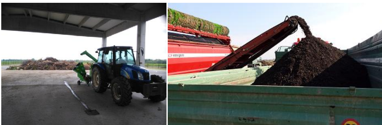
Slika 11. Sjeckalica i prosijavanje komposta
